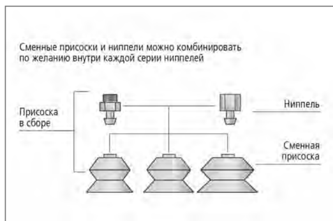
Конструкция сильфонных присосок FSG VU1 (2.5 гофра)
